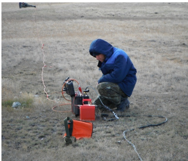
Рис. 4 Электроразведочная аппаратура «СКАЛА-64» во время проведения полевых измерений.
