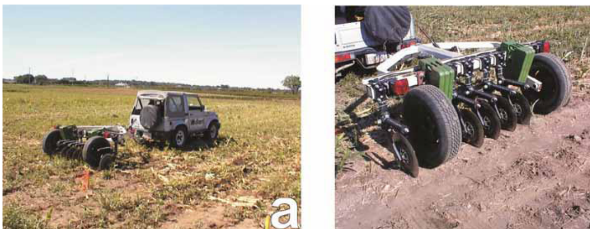
Рисунок 2. Пример непрерывного измерения удельного сопротивления с гальваническим контактом; (а) Veris 3100 Система картирования электропроводности (Veris Technologies, Салина, Канзас, США) и (б) крупный план стальных дисков, используемых в качестве электродов Veris 3100.
